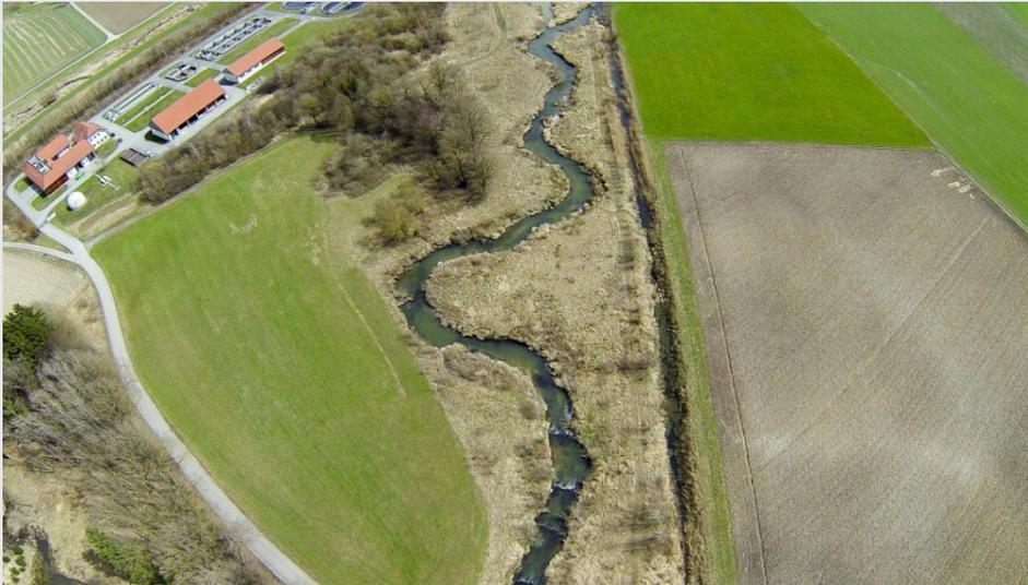
Große Maßnahme am Leitenbach, einem Zubringer der Aschach. In der Mitte sieht man den Bach, wie er wieder an den ursprünglichen Zustand angenähert wurde, mit Windungen und entsprechendem Flächenbedarf. Rechts davon erkennt man noch den regulierten, geraden Verlauf (der als Nebengewässer und als Hochwasserabfluss so belassen wurde).
